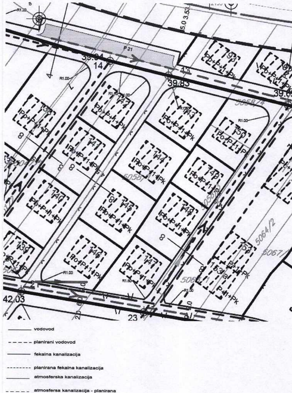
GRAFIČKI PRILOG – 09 Plan hidrotehničke infrastrukture Izvod iz DUP-a "Zabjelo B1" za urbanističku parcelu UP 143
