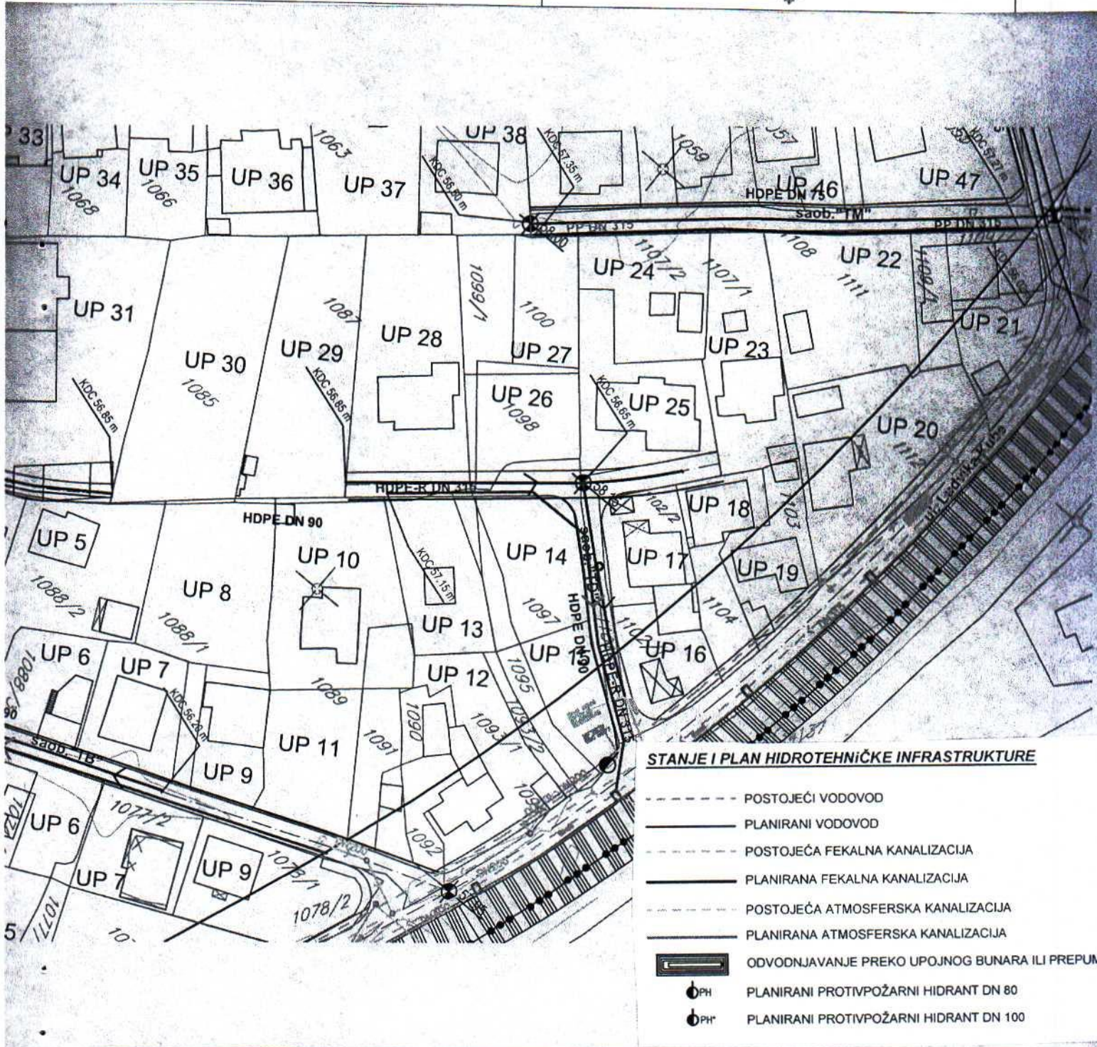
GRAFIČKI PRILOG –Plan hidrotehničke infrastrukture Izvod iz DUP-a „Zagorič 2“ u Podgorici Za urbanističke parcele B23-14,B23-15,B23-26,B-23-27
