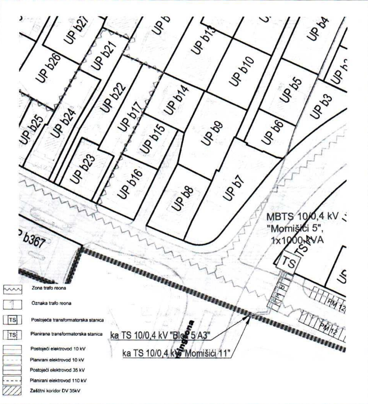
GRAFIČKI PRILOG – 08 Plan elektroenergetske infrastrukture Izvod iz DUP-a "Momišići B" za urbanističku parcelu UP b23
